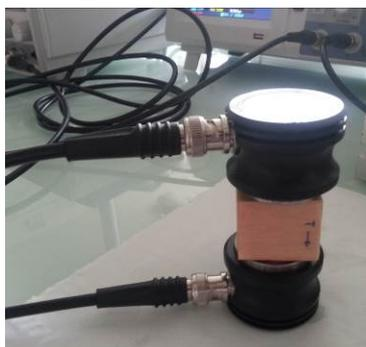
Fig. 1 : Essai ultrasonore de cisaillement en transmission (500 kHz)
