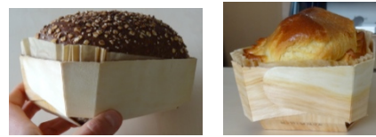
Fig. 5 : Moules après cuisson en four boulanger. Temps de cuisson : 24 min. T°C entrée : 254°C / T°C sortie : 266°C
