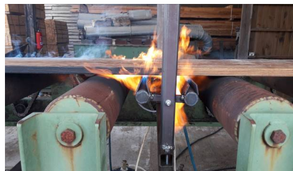
Fig. 2 : Essais de brûlage à l'aide du brûleur V2 implanté sur le convoyeur
