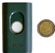
Fig. 1 : Photographie du spectromètre SCiO molecular sensor (Consumer Physics, Israël)
