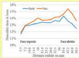
Fig. 2 : Répartition de l'humidité au sein d'un poteau d'ébène verte de 50 mm d'épaisseur (R) et 100 cm de largeur (T) à 0,10 m du sol (bas) et 4,90 m du sol (haut)
