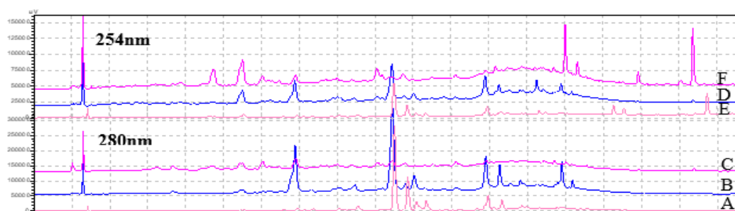
Fig. 3 : chromatogrammes UV à 254nm et 280nm des extraits éthanoliques de nœud et de branche d'épicéa. (A. Nœuds 280nm ; B. 1 re rondelle 0cm 280nm ; C. Rondelle à 250cm, 280nm ; D. Nœud 254nm ; E. 1 re rondelle 0cm 254nm ; F. Rondelle à 250cm, 254nm.)
