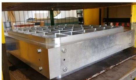
Fig. 5 : Moule aluminium en cours d'utilisation dans la presse
