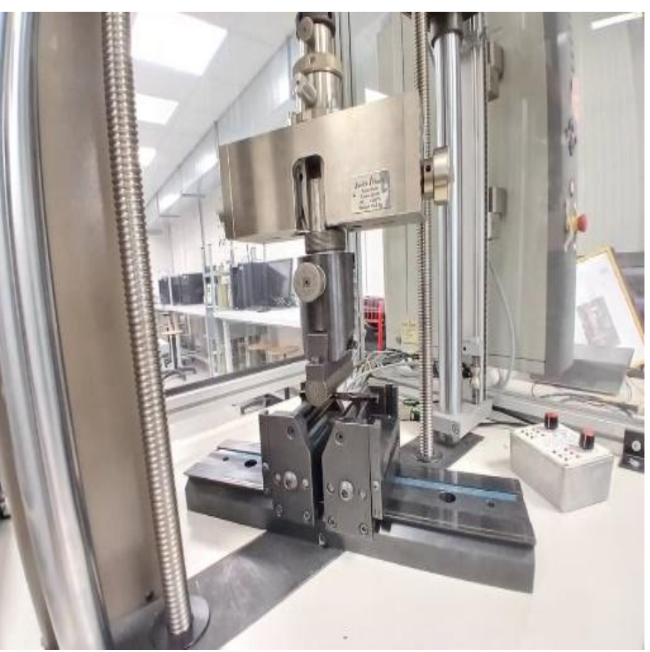
Machine de flexion (Presse Zwick Roell 2020)
