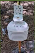
Fig. 1 : Capteur HOB0 de température et humidité de l'air ambiant a) installé au sein d'un abri à 1m30 du sol b) (protection contre le soleil, la pluie, le vent etc.).
