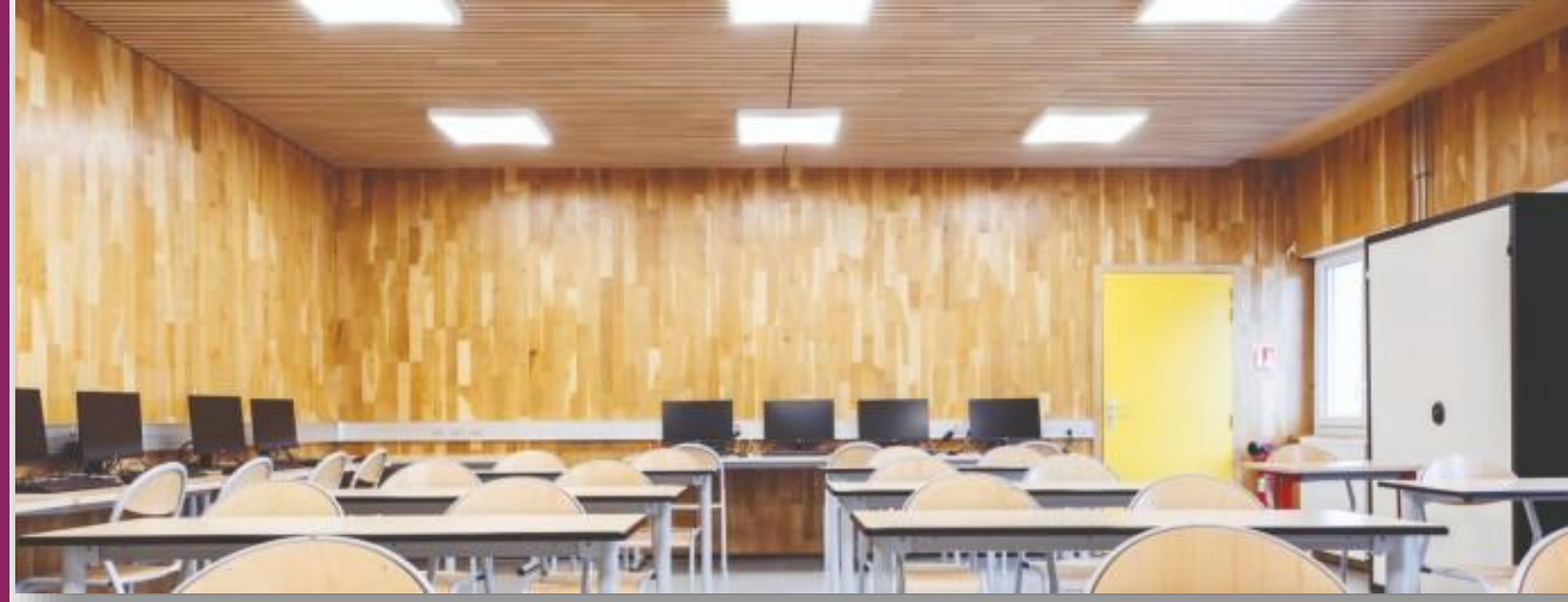
Exemple d'un produit technique novateur : le CLT chêne. Fruit d'une coopération étroite entre industriels et laboratoires de recherche, le CLT chêne est un produit développé autour de l'utilisation de bois de qualité secondaire en structure.
