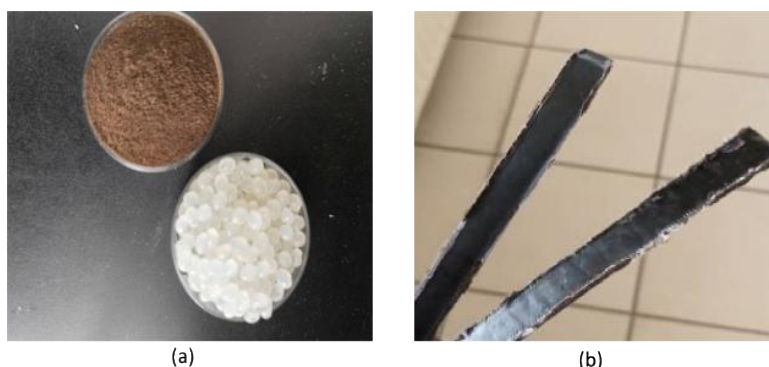
Fig. 1 : Fabrication des éprouvettes de flexion : (a) matériaux PLA 4043D et cabosses de cacao ; (b) composite PLA+PCC après démoulage
