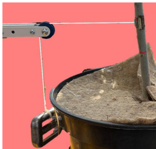
Fig. 2 : Photographie d'une expérimentation de tension radiale, sur une zone de tige isolée tangentiellement. Une pièce de plastique incurvée est collée à la surface de l'écorce et reliée à un poids de masse connue.
