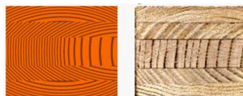
Fig. 7 : Rappel de la séquence d'empilement de GE5-4
