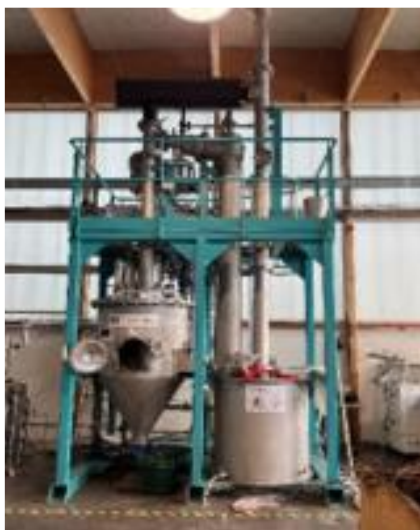
Fig. 2 : Pilote d'explosion vapeur, situé au Campus Bois à Epinal
