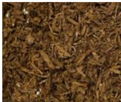
Fig. 6 : Particules de panneaux après explosion vapeur à 185°C-12 bar pendant 10 min
