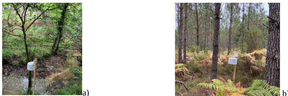
Fig. 3: Sondes de température installées dans leur abri proche de la rivière (a) et dans une plantation de jeunes pins (b) sur le site de Préchac (Sud-Gironde).
