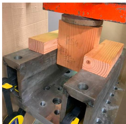
Fig. 4 : Essai push-out solive-vis-traverse
