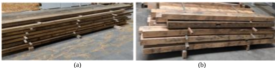
Fig. 1: Photos des lots de bois testés : (a) lot 1 d'épicéa (21 éprouvettes) ; (b) lot 2 de pin (27 éprouvettes)
