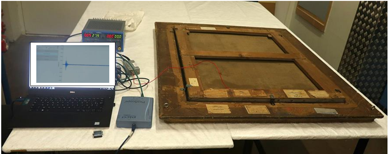
Photo 1 : Système ATAX complet dont le capteur est placé au revers d'un châssis d'une peinture de chevalet
