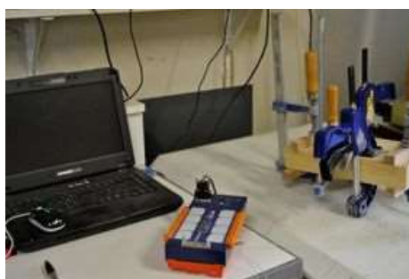
Système de mesure pour évaluer la cinétique du froid dans le bois
