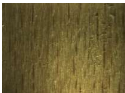
Mélange 10% carnauba / 90% abeille sur du bois après congélation dans l'azote liquide
