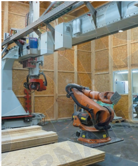
Robot anthropomorphe de marque Kuka Kr210-L180.
