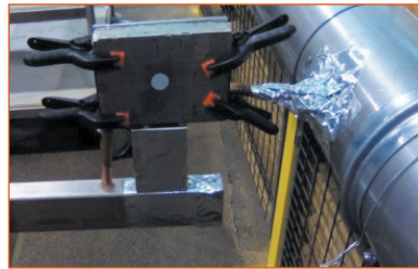
Prototype du nez n° 2 raccordé à la veine de sortie du banc.
