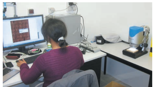
Mesure des états de surface grâce à un rugosimètre optique 3D
