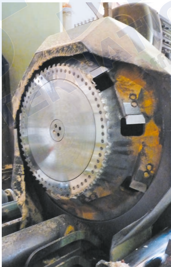
Modélisation et photographie de la coupe, Tête de fraisage LBL Brenta CD.
