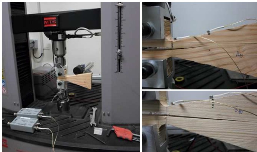
Fig. 1 : Eprouvettes DCB instrumentées pour l'Emission acoustique
