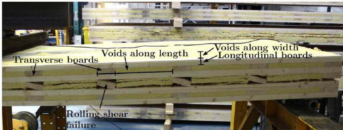
Fig. 3 : Rupture au cisaillement roulant dans les planches croisées
