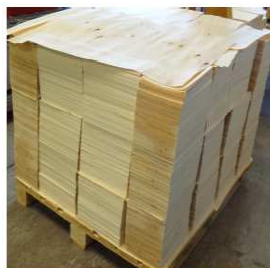
Fig. 1 : Palette contenant des piles de bois déroulé à l'état vert - 0,9 m de hauteur.
