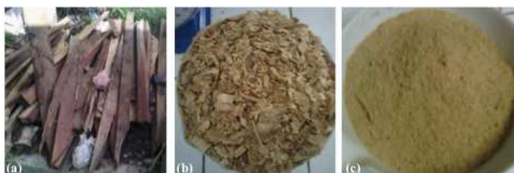
Fig. 1 : Déchets de bois utilisés : (a) morceaux de bois, (b) copeaux de bois, (c) sciure de bois
