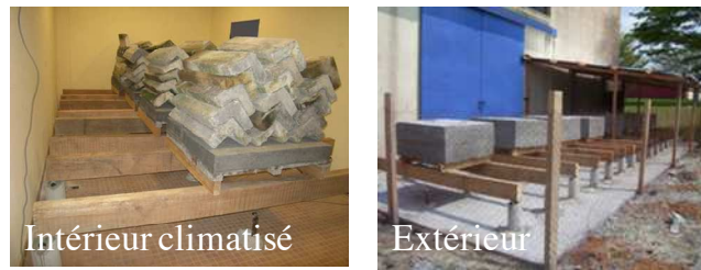
Fig. 1 : Essais de fluage en conditions de service
