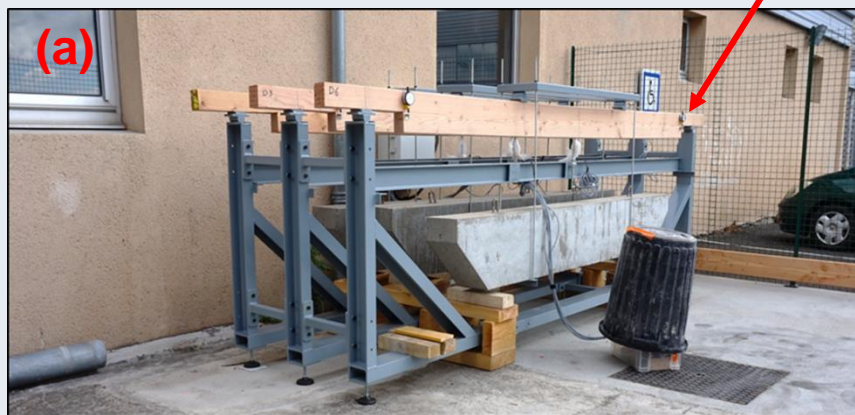
Figure 4: (a) Poutres de Douglas en essai; (b) Poutres de sapin Blanc en essai.
