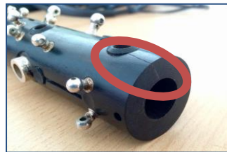
Exemple de clarinette fendue (cercle rouge) après fabrication
