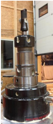
Outil de diamètre 14 mm à une dent.
