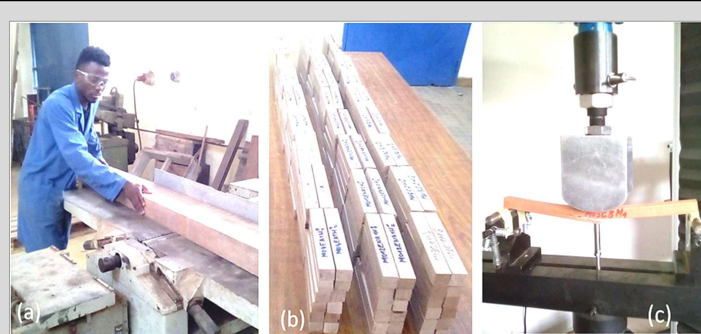
Fig. 3 (a) Dégauchissage de la poutre. (b) Eprouvettes de Moabi (haut, médian et bas). (c) Dispositif expérimental d'essai de Flexion 3 points
