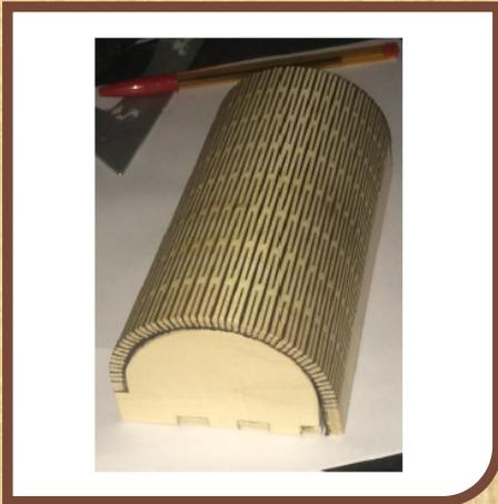
**Caractérisation de la flexibilité et de la résistance à la fatigue d'un treillis charnière bois**
