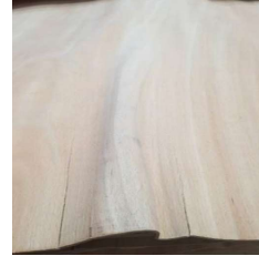
Placages secs : ondulations suspectées d'être causées par la présence de cerne blancs et/ou bois de tension
