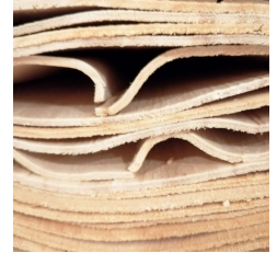
Placages secs : ondulations suspectées d'être causées par la présence de cerne blancs et/ou bois de tension
