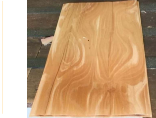
Placage plat après déroulage à l'état vert (avant séchage) présentant des cerne blancs
