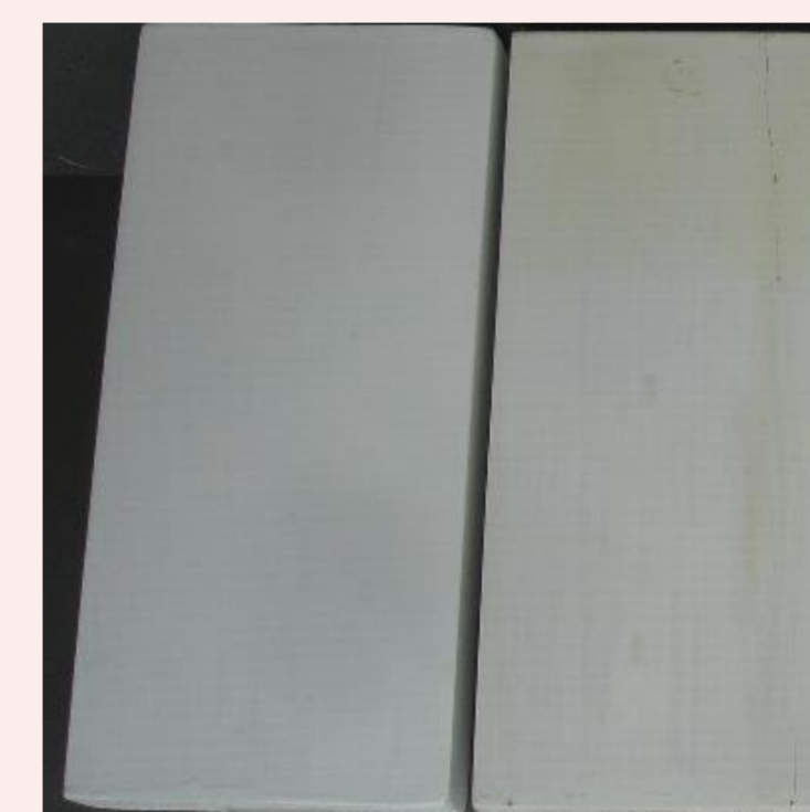
Eprouvettes des revêtements C et D sur pin Sylvestre avant (à droite) et après (à gauche) 12 semaines de vieillissement artificiel
