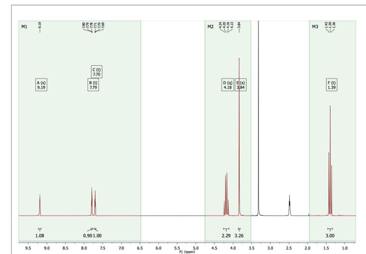
A 1 équivalent de 1-méthylimidazol est ajouté 1,2 équivalents de bromoéthane. Le mélange est placé dans un ballon à reflux sous agitation pendant 72h à 40°C. Ensuite l'excès de bromoéthane est évaporé et le liquide ionique caractérisé par une RMN <sup>1</sup>H. RMN <sup>1</sup>H de EmimBr (200 MHz, DMSO-d<sub>6</sub>) δ 9.19 (s, 1H), 7.79 (t, J = 1.8 Hz, 1H), 7.70 (t, J = 1.7 Hz, 1H), 4.18 (q, J = 7.3 Hz, 2H), 3.84 (s, 3H), 1.39 (t, J = 7.3 Hz, 3H)
