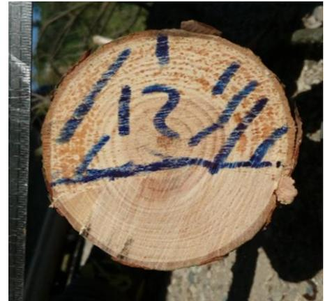
Fig. 2 : Photo d'une section de branche. La surface hachurée représente la partie sciée. La partie inférieure représente la portion résiduelle de section au moment de la rupture.
