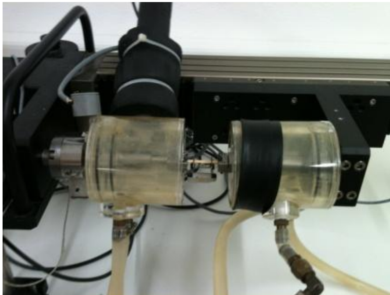
Machine de traction équipé d'une cellule hygothermique
