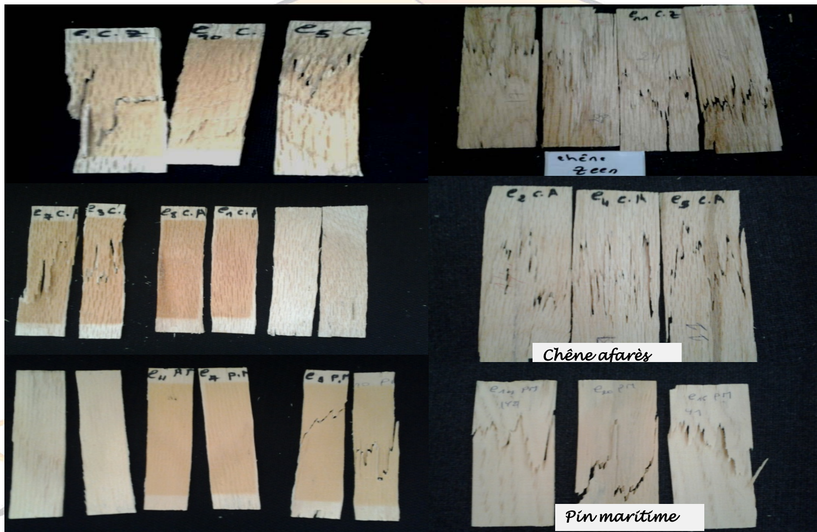
Fig. 4 : Modes de rupture en traction sur éprouvettes ; ayant subi une immersion (a) et un vieillissement (b)
