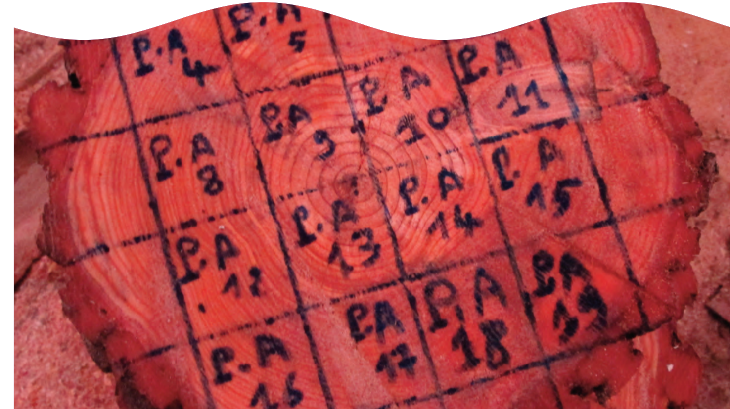
Pin d'Alep. Marquage des éprouvettes d'essais physiques et mécaniques
