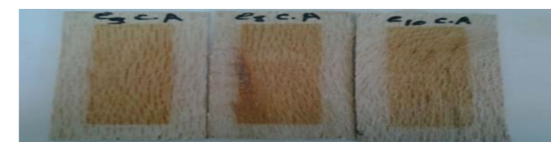
Fig. 7 : Eprouvettes de Chêne Afarès après 120h au sein de l'appareil « Xénostest »
