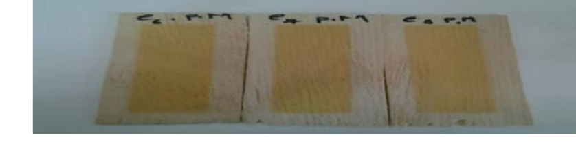
Fig. 11 : Eprouvettes de Pin maritime après 120h au sein de l'appareil « Xénostest »
