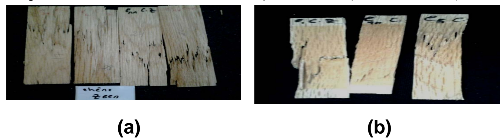
Fig. 5 : Modes de rupture en traction sur éprouvettes ; ayant subi une immersion (a) et un vieillissement (b)
