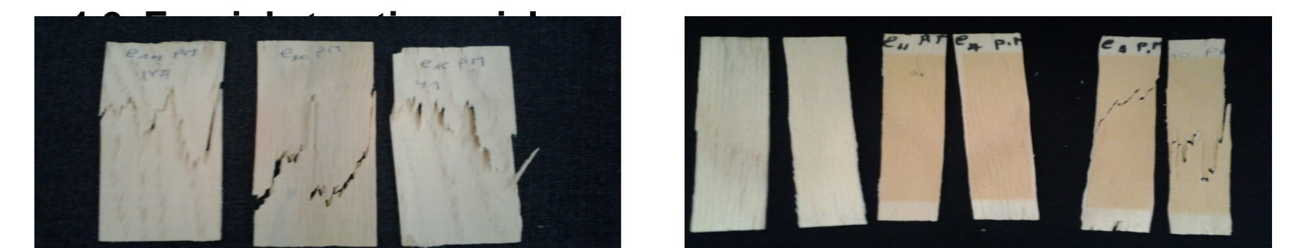
Fig. 13 : Modes de rupture en traction sur éprouvettes ; ayant subi une immersion (a) et un vieillissement (b)
