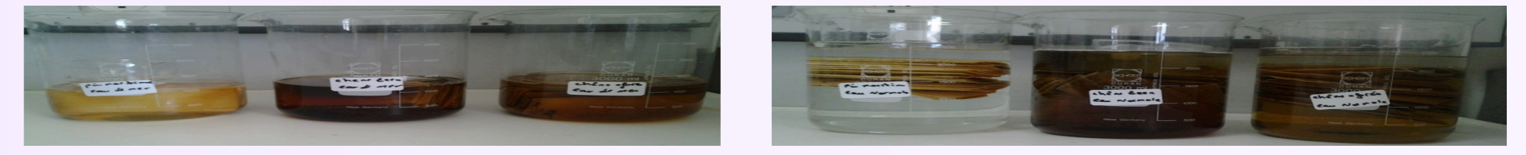
Fig. 1 : Essais d'éprouvettes immergées dans l'eau de mer (a) et l'eau normale (b)
