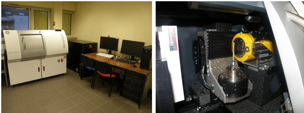
a) Dispositif de microtomographie à rayons X installé a l'INRA de Clermont-Ferrand et b) vue de la chambre.
