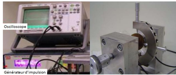
Figure 89 : Dispositif expérimental ultrasonore en transmission (couplage par gel).
