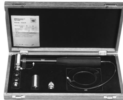
Figure 21 : Marteau instrumenté (Briel & Kjaer, type 8202).
