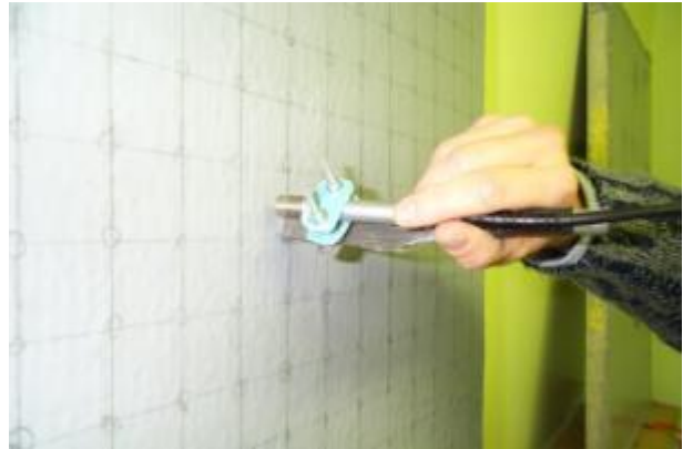
Figure 104 : Détail d'un essai par contact frottant.
