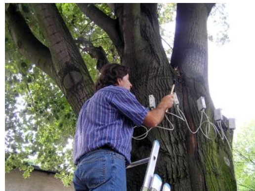
Figure 65 : Tomographe Arbotom ( http://www.rinntech.de/ ).
