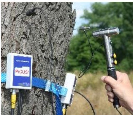
Figure 64 : Tomographe Picus ( http://www.argus-electronic.de/ ).
