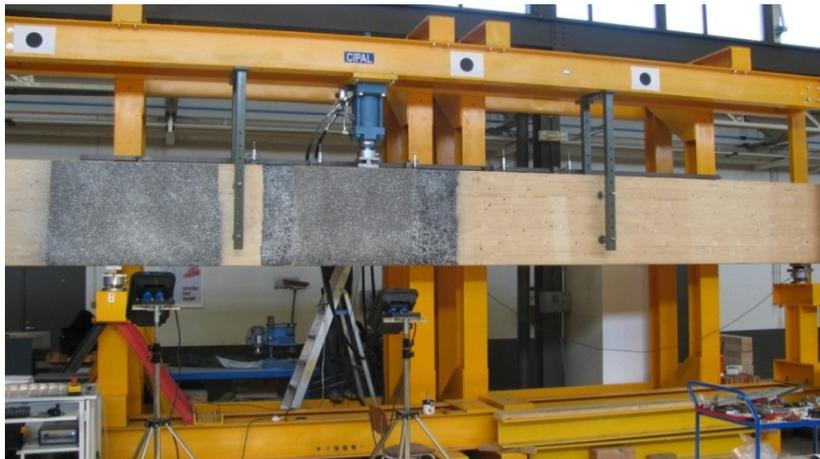
Figure 1 : Dispositif d'essai des poutres en flexion
