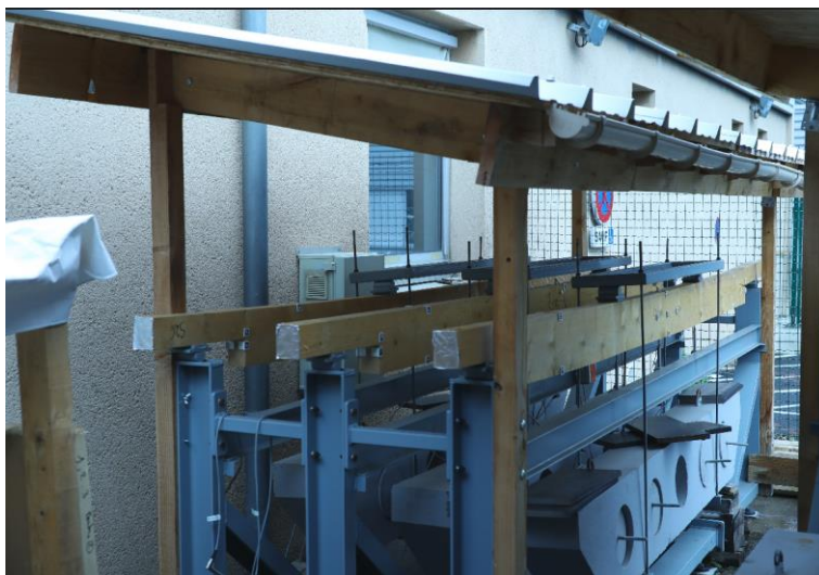
Campagne d'essais de fluage sur du bois partiellement séché, avec fissuration !
