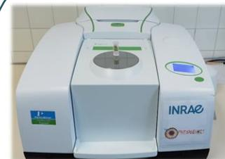
Spectromètre proche infrarouge
