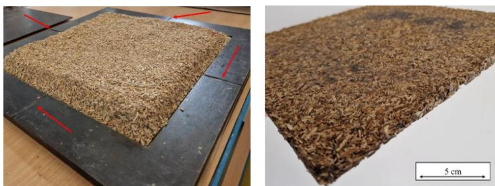
Fig. 5 : (gauche) Utilisation d'un moule usiné permettant l'évacuation du surplus de vapeur pendant la phase de thermocompression. (droite) Panneau GR-AB-3 obtenu de granulométrie 0,5 mm à 4 mm.
