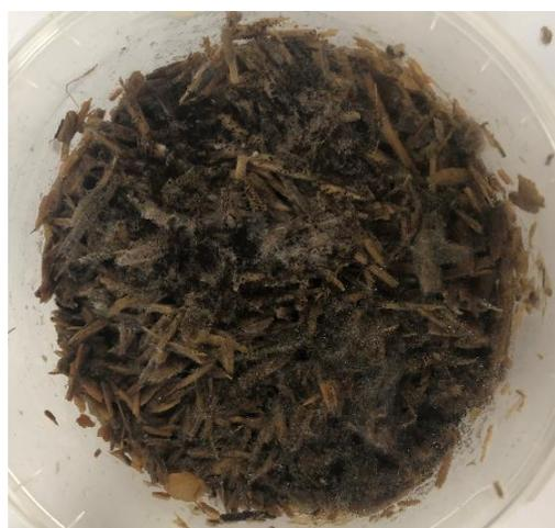
Fig. 8 : Mycocomposite avec du bois recyclé non traité
