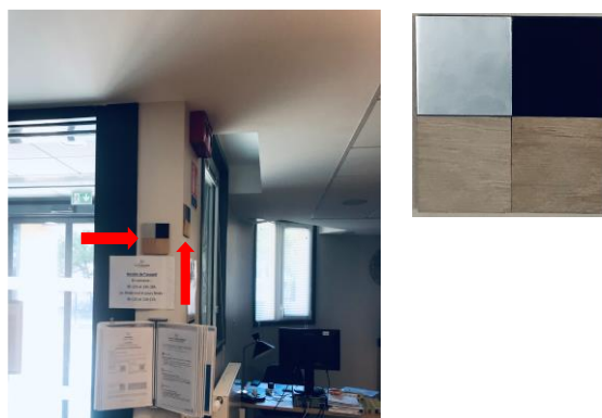
Fig. 1 : Positionnement des coupons installés dans un établissement de santé et détail du coupon (photos prises par Morel ESSONO)
