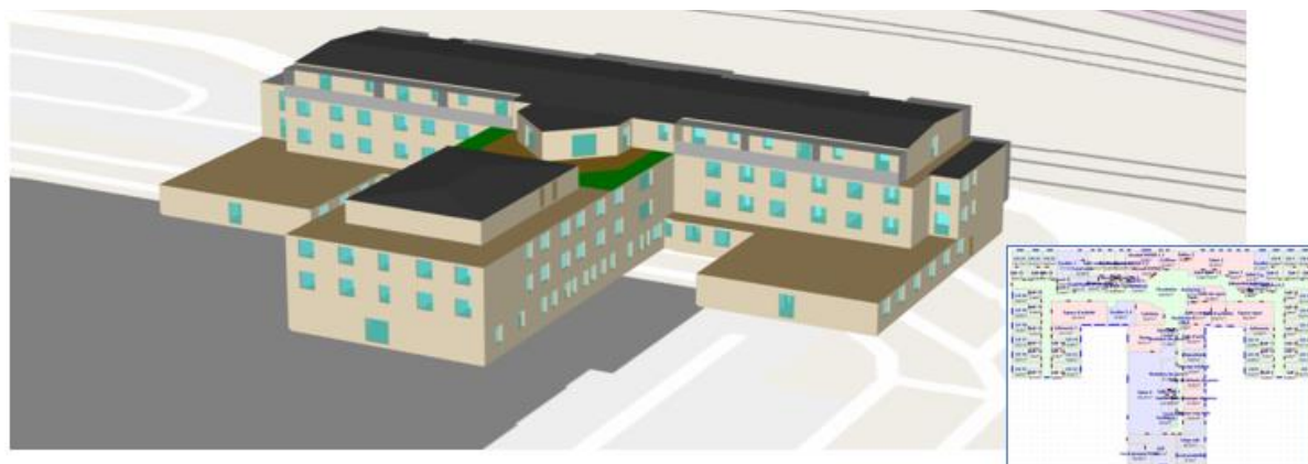
Fig. 2 : Vue 3D de la modélisation complète du bâtiment B3 (réalisation sous logiciel Pléiades, avec plan 2D détaillé de chaque étage permettant une simulation STD ou ACV)
