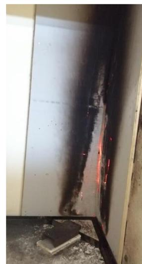
Fig. 9 : Panneau Alumine Zircone à la fin des essais SBI de réaction au feu.
