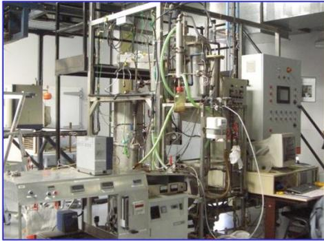
**Réacteur de pyrolyse "flash" en lit fluidisé**
