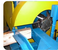
Équarrissage (Source Forintek)
