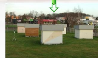
5 Enveloppes de géométrie simple, dénommées modules-test, instrumentées et soumises à des conditions intérieures régulées et des conditions extérieures réelles.
