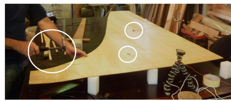
Ci-contre : mesures au marteau d'impact et deux accéléromètres effectuées sur une copie en cours de fabrication (avant et après barrage).
